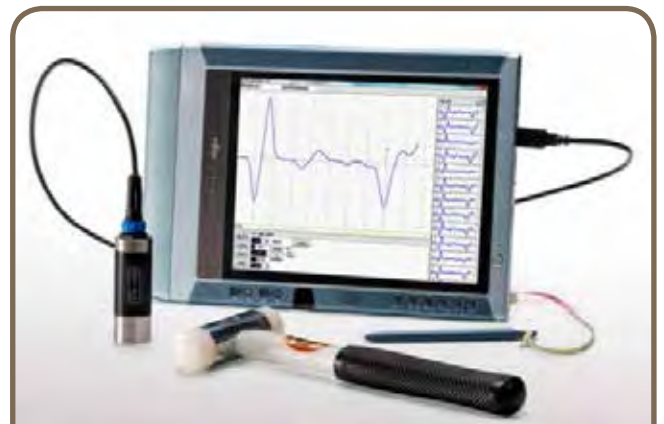
Fig.2 Equipo PET (Pile Echo Test) con acelerógrafo y Reflectograma para interpretación frecuencias de onda.
