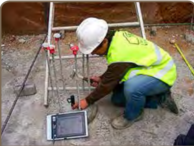
Fig. 13. Ejemplo de evaluación con ensayo PET de un pilote.
