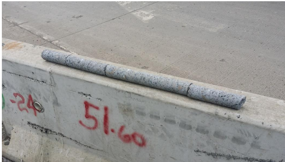
Extracción de núcleos en pilotes Zonas afectadas determinadas con Tomografía
